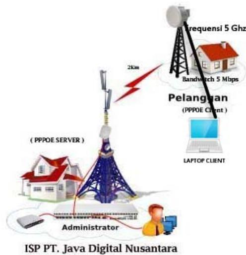
Gambar 10 Topologi Pengujian frekuensi 5 Ghz
